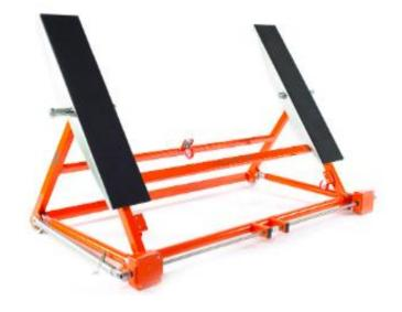
Автомобильный подъемник механический, приводится в движение при помощи электродрели. Два редуктора современной конструкции с трапецеидальными винтами внутри рамы позволяют быстро поднять или опустить автомашину.
